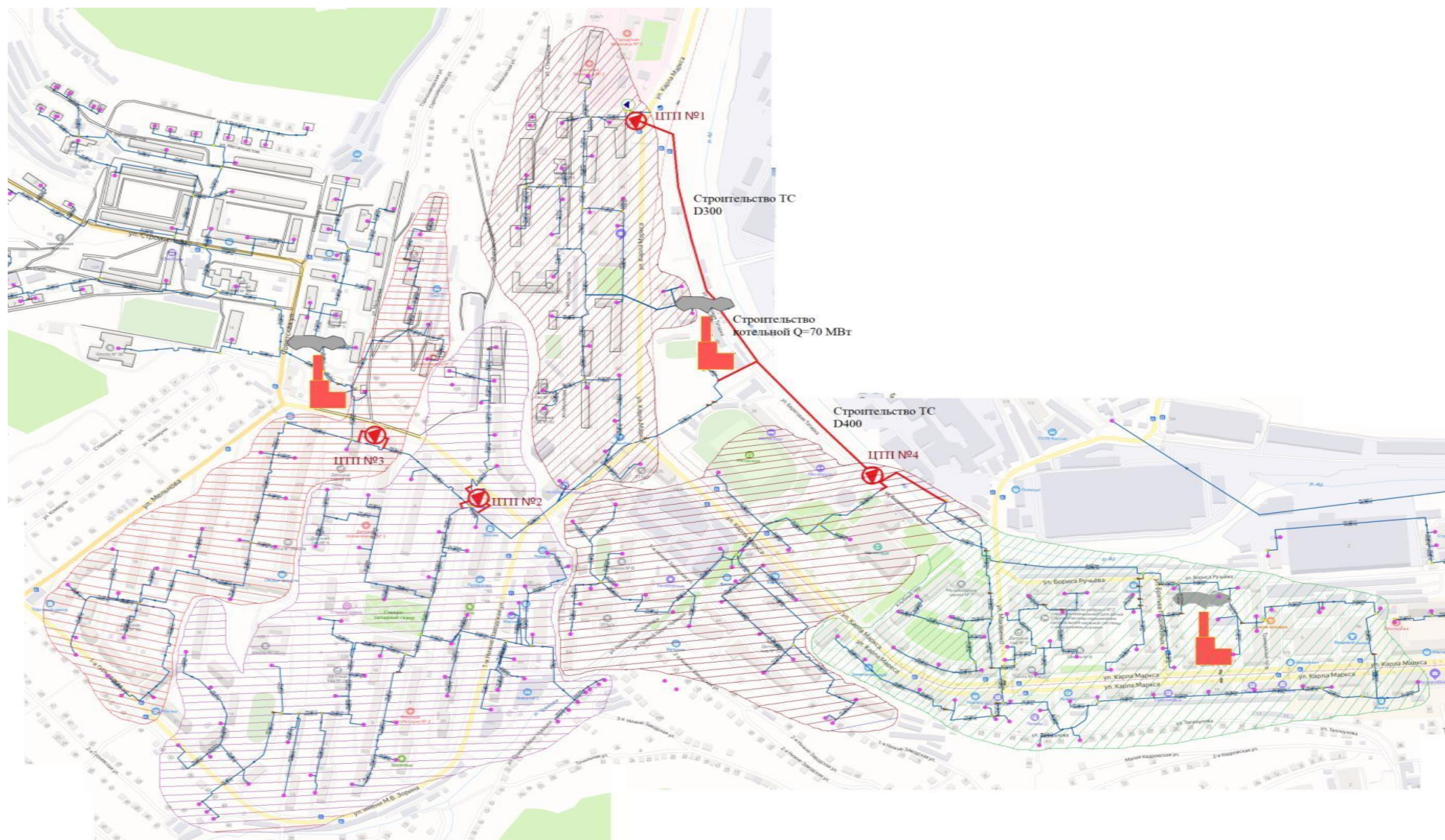
Рис. 4.2.1-1. Размещение котельной №1 и ЦТП на территории ЗГО.
